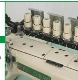
外推式下勾针穿线机构，可使下勾针外推，穿线容易。
